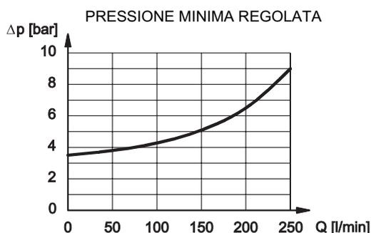
N.B. La massima portata utilizzabile all'attacco P<sub>1</sub> di alimentazione dei P2D - P4D è di 120 l/min.
