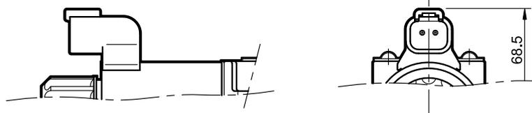
Ventilanschlussstecker DEUTSCH-Connector Typ DT04-2P für Gegenstecker DEUTSCH-Connector Typ DT06-2S.-Spule mit Diode
